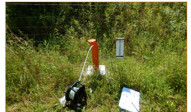
Exemple de piézomètre permettant de réaliser un suivi semestriel de la qualité de la nappe
